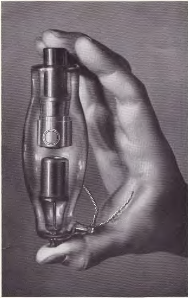
Bild 5. Die nur 12 cm lange Spezial-Röntgenröhre der SIEMENS-RÖNTGENKUGEL
