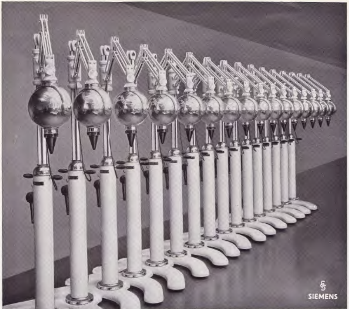
Bild 32. Serienbau von SIEMENS-RÖNTGENKUGELN
